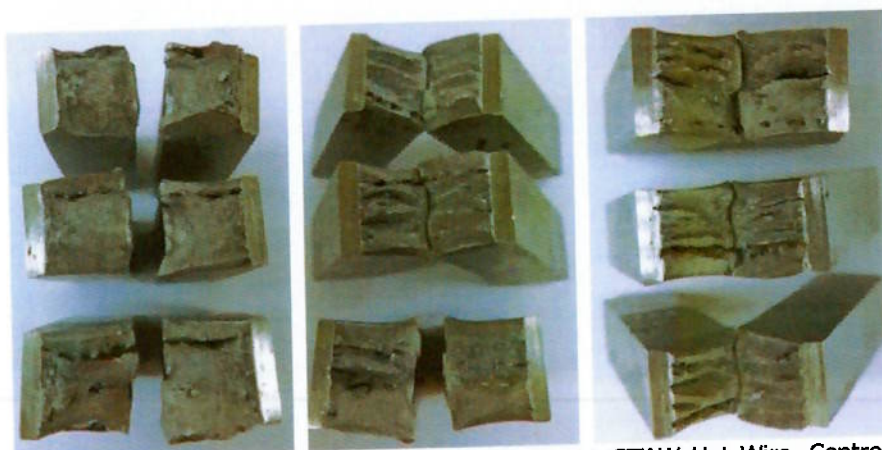
Figura 5.4 – CPs obtidos no ensaio de impacto no processo GTAW Hot Wire. Centro de Solda (esquerda), Linha de Fusão (central) e Linha de Fusão +2mm (direita).
