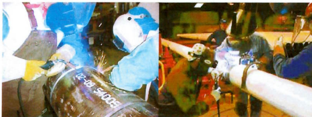
Figura 3.26 – Soldagem de passe de raiz em tubulações [42]
