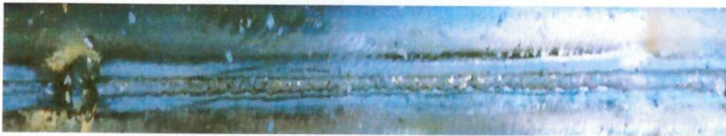
Figura 4.11 – Configuração do posicionamento da tocha GMAW e resultado da raiz
