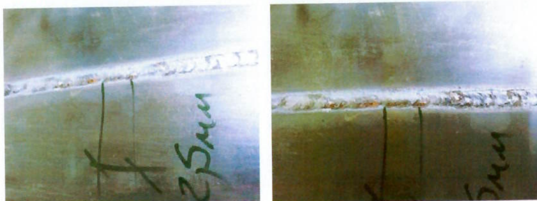
Figura 4.5 – Penetração do passe de raiz
