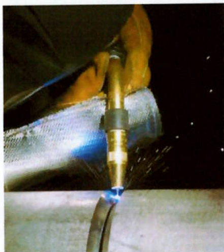
Figura 3.23 – Soldagem de Passe de Raiz GMAW com Transferência Controlada [50]
