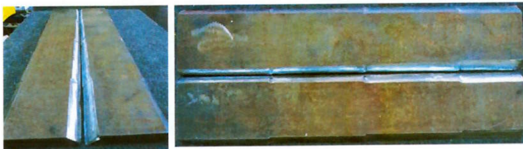
Figura 4.2 – Ajuste do ângulo da junta
