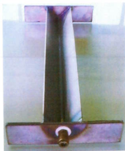
Figura 4.10 – Dispositivo para purga do gás de proteção da raiz
