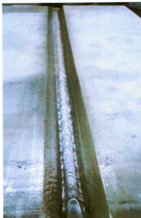
Figura 4.14 - Passe de Raiz no processo GMAW de transferência controlada.
