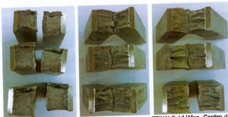
Figura 5.3 – CPs obtidos no ensaio de impacto no processo GTAW Cold Wire. Centro de Solda (esquerda), Linha de Fusão (central) e Linha de Fusão +2mm (direita).
