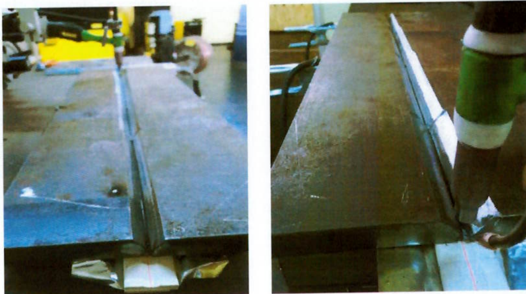
Figura 4.6 – Soldagem com cobre-junta cerâmico
